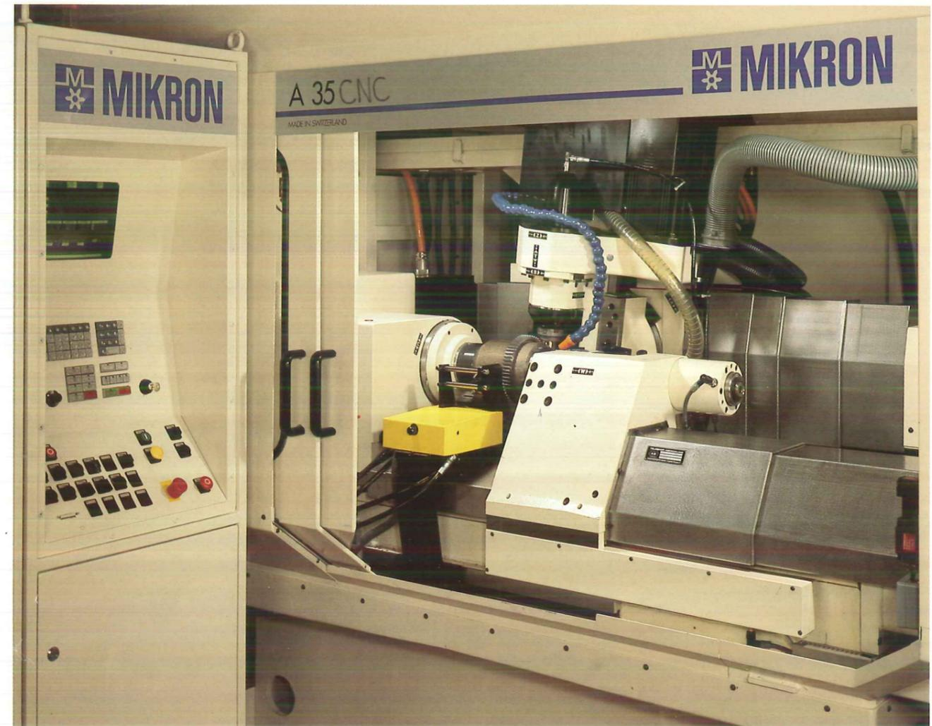
Fräser-, Werkstück- und Reitstockspindel sind mit hydraulisch betätigten Schnellspannsystemen ausgerüstet. Werkzeugwechsel erfolgen schnell und mit hoher Wiederholgenauigkeit.
