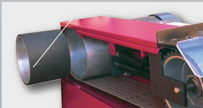
Durchgehende Planschleiffläche zur Bearbeitung von längeren Werkstücken.
